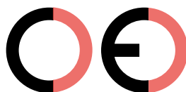
Faux marquage CE (trop éloigné)
